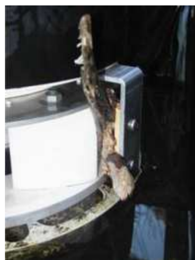
例えば自動掃除機構があっても棒が絡んで、装置停止例(LH Pro) この場合回転方法は時計回転方向反対になり、絡み付きリスクを低減。
