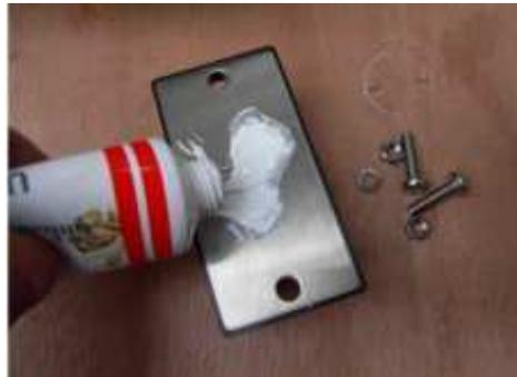
熱伝導ペーストを、収納部に固定する前に整流器側に薄く延ばして塗っておきます。
