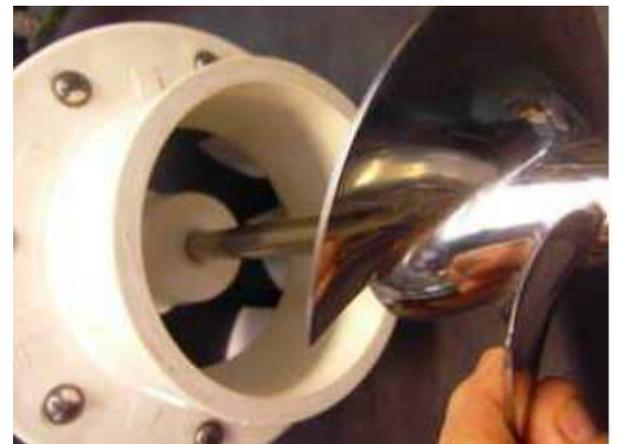
大型スパナ2個で2個のPVC ネジ付固定部を外す。右の写真のようにヘッドアッセンブリーを外す。次にベアリングブロックを引き出す。
