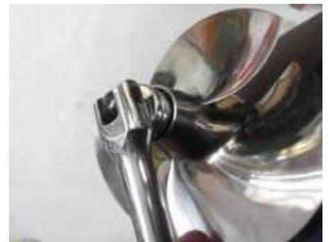
シャフトからプロペラを取るには、先ずナットを取ります。もしナットが固定されすぎ、全ての部品が回る場合、スクレュードライバーのテクニックを工夫します。溝を切った金属棒をドライバーシャフトに押し込み、グイとシャフトからプロペラをぐいぐい引き出します。
