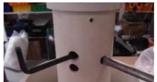
このカップリングの最終固定前に、プロペラガイドの上の木の葉カッターバーとプロペラの羽が接触しているか確認が必要です。プロペラの上の端がカッターバーに触れる様プロペラとシャフトを樹脂ハンマーで叩いて調整します。その後手で回転して問題ないか確認が必要です。シャフトをカップラーの端をハンマーで叩いてもカッターバーに触れない場合、拡張固定金具を緩め、プロペラ自体を少し上方向に引き上げて、触る位置に合わせる必要があります。
