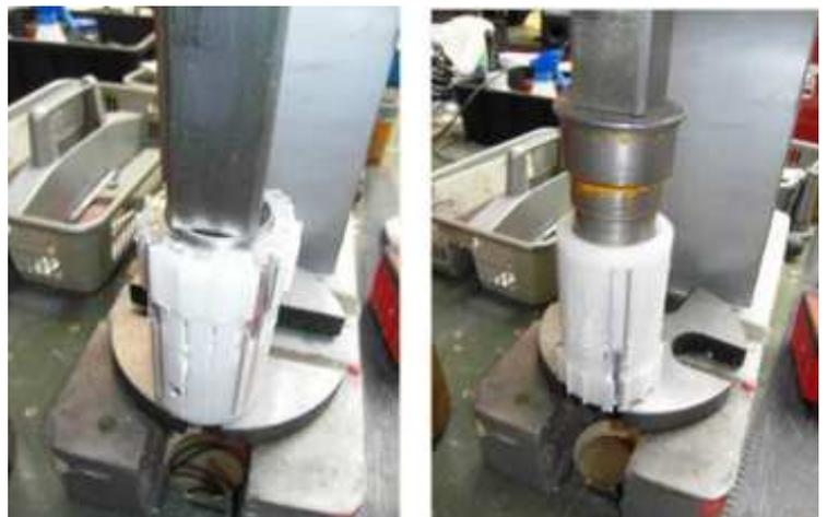
メチル系の溶剤で全ての場所を清掃します。ベアリング固定接着剤を内側ベアリングの突き出た場所に一滴落とし、又シャフトにも一滴落とし平均に伸ばします。(右写真)。シャフトをベアリングブロックに挿入しナット締めを行います。シャフトを手で回し、自由に回る事を確認します。ナットを締めすぎない事。手で締める程度で、後は接着剤が固定します。
