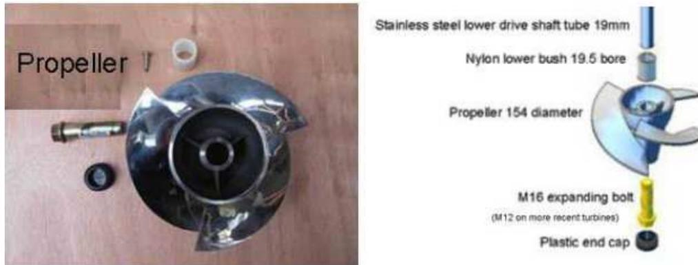
白いナイロンブッシュは予備部品で、日光の当たらない安全な場所に保管して下さい。毎年この部品は交換します。2015年より大きいODのPTFEも利用出来ます。貴方のブッシュと拡張ボルトのODを計測しご注文ください。この辺りの部品変更は多く、外側直径(OD)の確認が必ず必要です。
