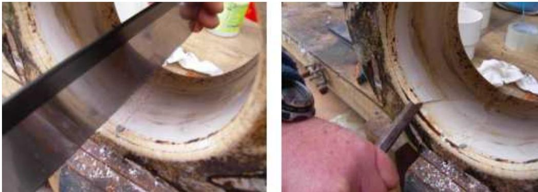
新しい物を接着剤で止め旋盤で内部表面を均一に切り込みます。プロペラも外径が均一か、再加工が必要なら、削り真円にします。
