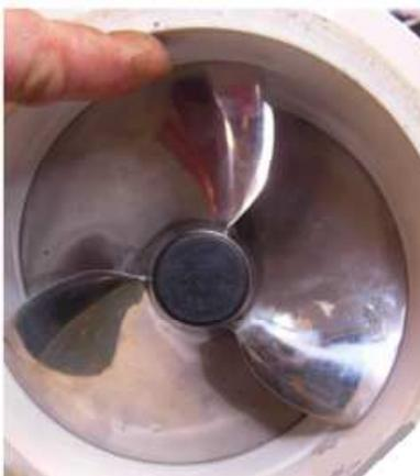
プロペラが中央部で回転しているか確認するには便利な方法があります。梱包材のプラスチックを薄くカットし、詰め物状の物を作りそれを羽のはしとPVCガイドライナーの間に置きます。
