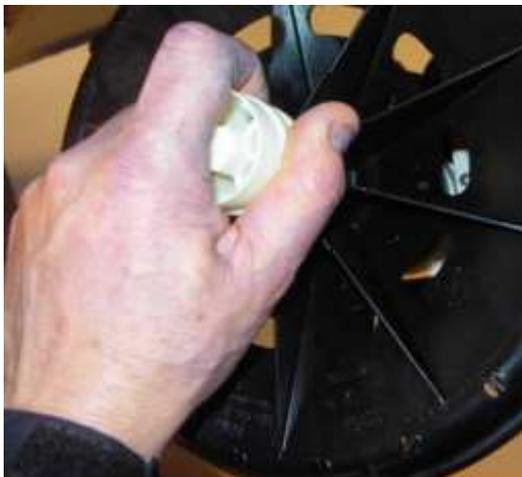
回転側 ローターに見える軸の上の溝やローター自体の取付け穴の内部に、グリスや 焼き付防止剤を丁寧にコートし、その後、固定ノブを押し込みます。
