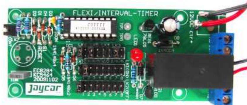
自動動作時間設定は、環境に応じ変更可能です。ジャンパー位置で調整します。しかし基本は12分の間に2分以上の動作は避けなければなりません。これ以上の頻度では、モーターの消耗が加速されます。
