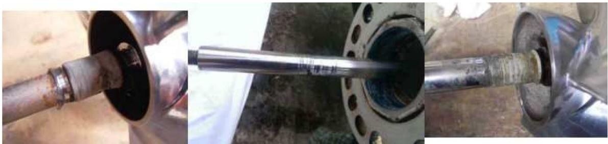
プロペラガイド部は160mmOD PVCの切れ端を使い、接着剤で固定しており、プロペラのODに合わせて入れ込まれています。古いライナーを取るには垂直に切り目をたくさん入れ、のみで掘り込み取り出します。熱風を吹きつけながら作業すると剥がし易くなります。
