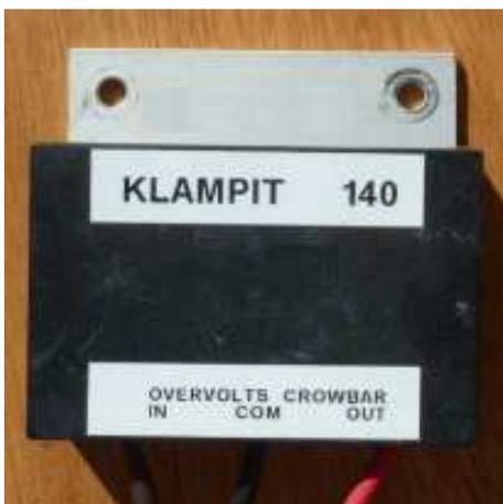
一定電圧安定器とも言える安全装置で危険電圧に到達した時点でタービンを自動的に短絡します。本装置が働くと、発電機のVocは一定以下に抑えられ、再開時には正常の電圧に戻ります。負荷事故発生時、安定したシステムが守られます。
