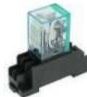
負荷に切り替えられた時点で、このリレーには余剰の電流が流されます。となると、蓄電池に向かう電流は瞬間に減少し、電圧低下が発生します。となると、負荷に切り替わった回路は復帰を始めます。この切り替わりが頻繁に行われないう、電流操作は正常電圧の少し上を走る様平均を取らねばなりません。頻繁な切替運動はリレーの寿命低下につながります。このOn/Offのスイッチタイムの適正はダミー抵抗にも健康な状態を作りますが、あまり緩慢にした場合、蓄電池電圧の正常性を保てなくなります。
