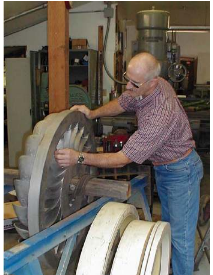
著者は重さ 450kg、ピッチ 22 インチ、ターゴランナーを検査しています。このランナーは 880kW 発電用。
