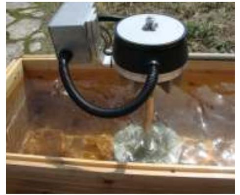
常に一定した水槽の水位の保持が、安定した発電に寄与します。水の供給量は季節ごとに変動しますので、水の豊富な季節用にオーバーフロー用排水堰を水槽の先端部に設けてください。
