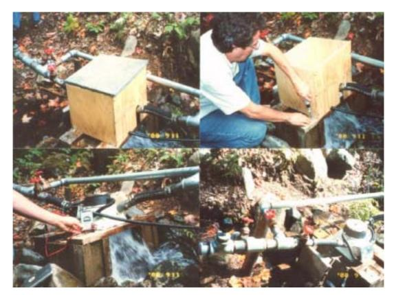
発電装置の保護板をはずし実際の水の流れを確認。写真は2 ノズル型。テスターで 実際の出力ボルト確認。
